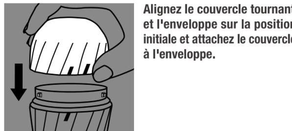
Alignez le couvercle tournant et l'enveloppe sur la position initiale et attachez le couvercle à l'enveloppe.
